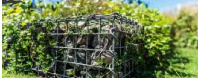
Los gaviones decorativos están compuestos por mallas de acero electrosoldadas previamente galvanizadas en caliente. Diámetro de hilo de acero: 4 mm, luz: 50x50 mm. Tensores internos zincados de 4 mm para garantizar la cubrición del conjunto lleno.
