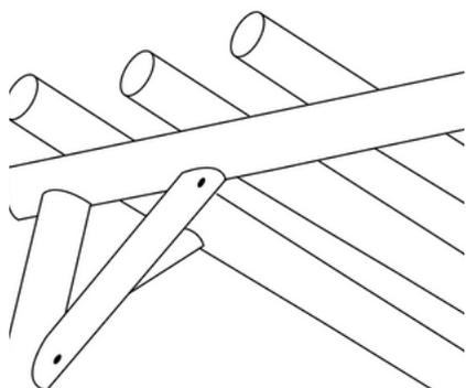
10 Se fijan las varillas con tornillos 6x120
