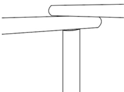
**06** Se fijan los tornapuntas con tornillos 6x120 con la boquilla
