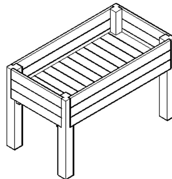
Montar las lamas de la base colocandolas sobre las 2 viguetas de refuerzo y colocar la malla geotextil.
