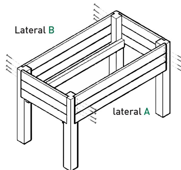
Completar el montaje de las cuatro lamas largas superiores. Repetir esta operación en los dos laterales
