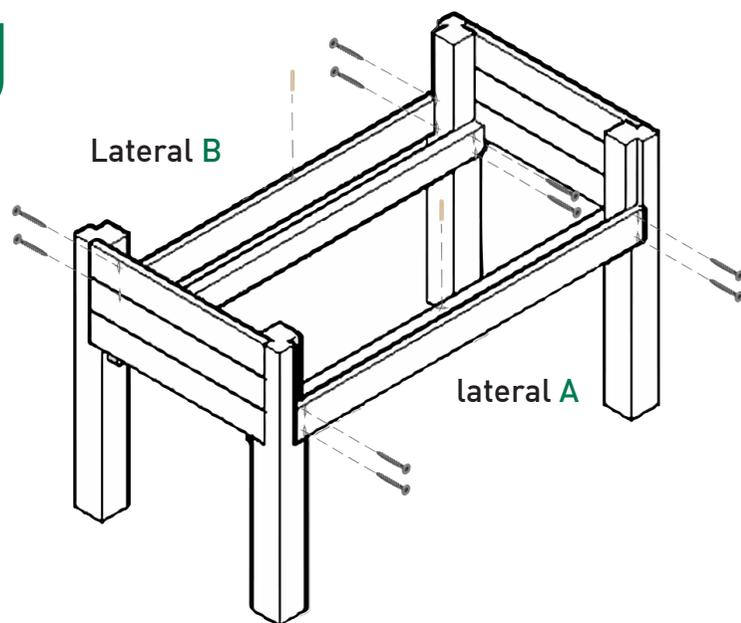
Montar las 2 lamas largas inferiores y atornillar las 2 viguetas de refuerzo. Repetir esta operación en los dos laterales
